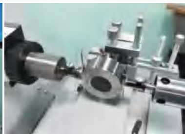
螺纹塞规的中径测量
